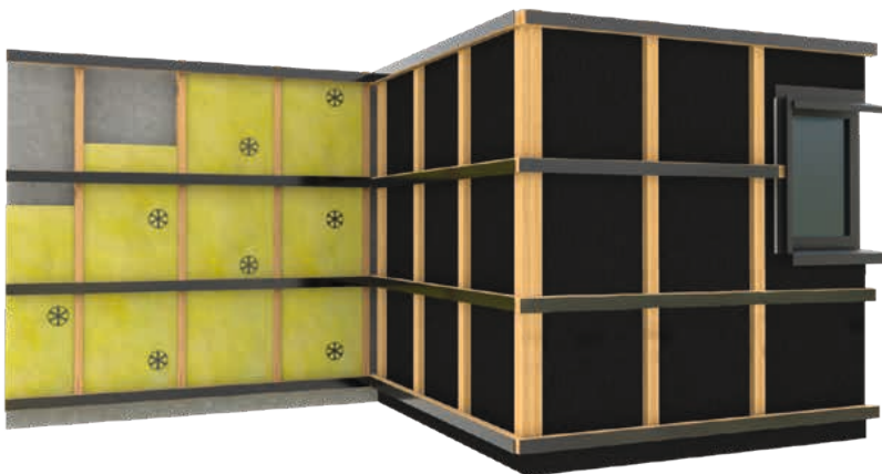
Konstruktion ohne Fassadenbahn
